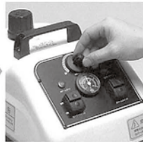
スチームバルブを開き、スチーム量の調節をする(2~4 kgf/cm 2 が最適)
