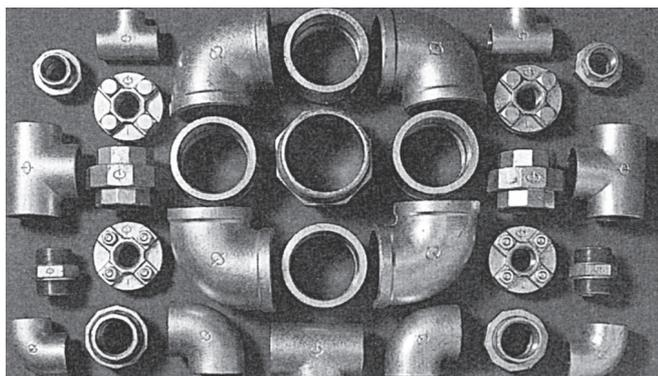
JIS B 2301 「ねじ込み式可鍛鉄製管継手」規格品で、材質はJIS G 5705 「可鍛鉄品(FCMB27-05)」を採用しています。白品は環境負荷物質を含まない「eめっき」を施しています。但し、一部JIS規格に含まれていない呼びも掲載しています。
