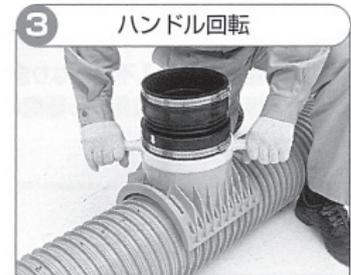
封印シールをはがし、ハンドルを時計回りに回転(約3回半)させます。
