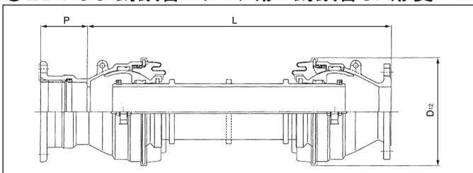
●EB-UGSG 鑄鉄管GX形受口×鑄鉄管GX形挿口
