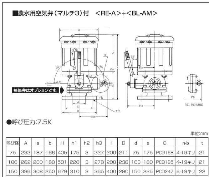
注) 既設の空気弁の本体のみを取替える場合、φ75以上のプラスにはフランジがなく、挿込ボルト式の補修弁には直接取付ける事ができませんので、ご注意ください。
