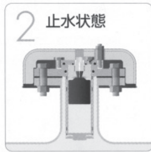
遊動弁体、フロート弁体が浮力・水圧により大空気孔、小空気孔をふさぎ、水の流出を防ぎます。
