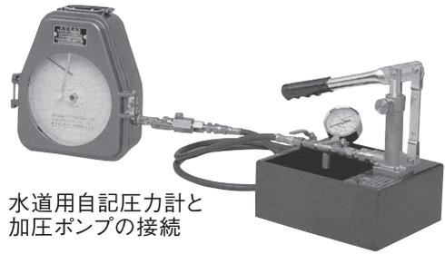
水道用自記圧力計と加圧ポンプの接続
