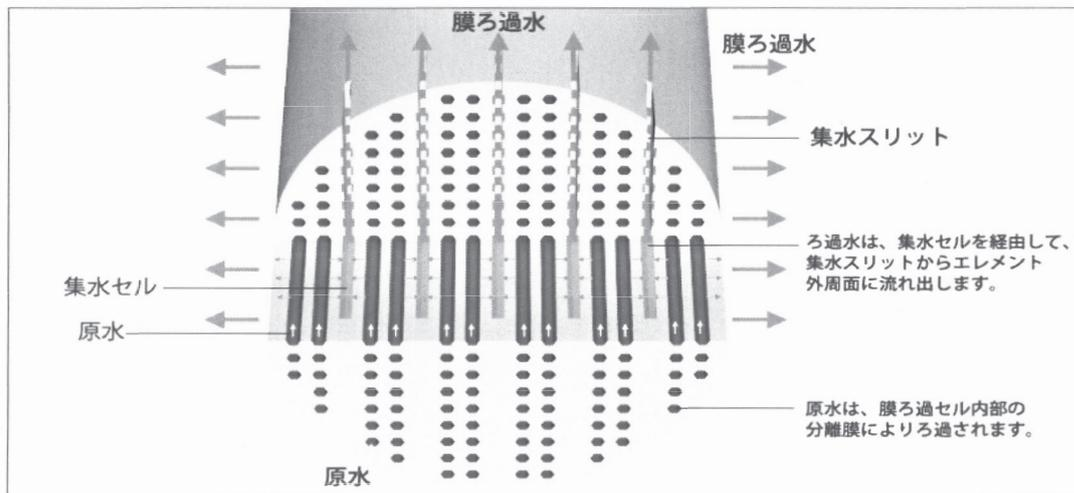
セラミック膜 水の流れの構造
