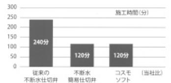
コスモソフトは本バルブ型にも関わらず、新開発のケース構造とコンパクト設計の工具により既存の本バルブ工事に掛かった時間の半分で施工を完了できます。これは、不断水簡易仕切弁と同等の施工時間で本バルブが設置できるということです。
