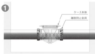
1 既設管にケース本体・離脱防止金具を取り付けます。その後、水圧試験を行い、確実に取り付けられたことを確認し、作業弁・穿孔機を取り付けます。
