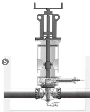
5 弁体を所定の位置まで挿入し、固定します。
