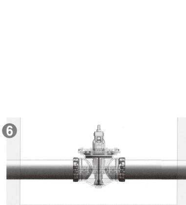
6 漏水の有無を確認し、挿入機・作業弁を取り外します。本体蓋を取り付け、設置は完了です。
