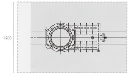
当社の簡易仕切弁のみならず、他社の簡易仕切弁とも同等の掘削面積で規格型の本バルブを設置可能です。
