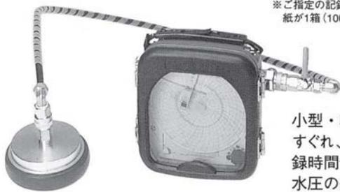
小型・軽量で携帯性にすぐれ、長短5段階の記録時間切替機能を持ち、水圧の経時変化の記録を正確に行います。
