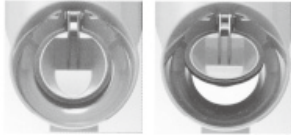
通常時は、逆止弁が閉じているので逆流を防止します。 逆止弁の開閉はスムーズなので排水詰まりもありません。
