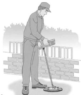
管路の探査例
