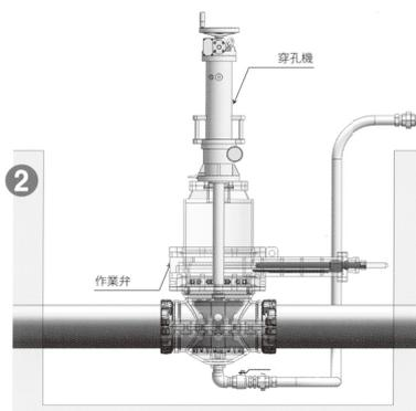
2 作業弁を開き、穿孔を開始します。この作業弁は弁の開閉により、穿孔した後も流体が外部に漏れないように作業を進めるためのものです。
