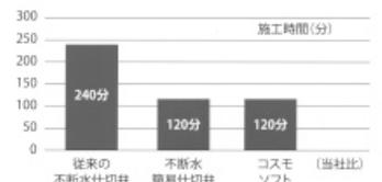
コスモソフトは本バルブ型にも関わらず、新開発のケース構造とコンパクト設計の工具により既存の本バルブ工事に掛かった時間の半分で施工を完了できます。これは、不断水簡易仕切弁と同等の施工時間で本バルブが設置できるということです。
