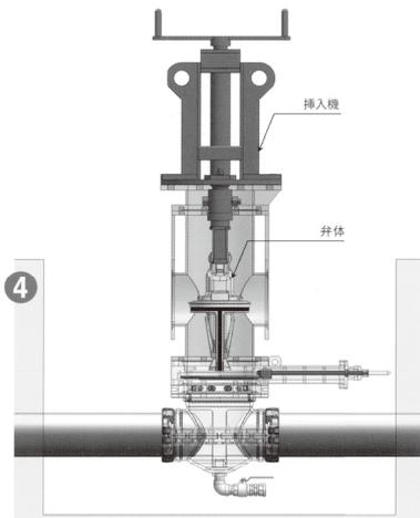
4 穿孔機を取り外し、挿入機・挿入する弁体を設置します。
