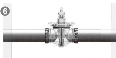
6 漏水の有無を確認し、挿入機・作業弁を取り外します。本体蓋を取り付け、設置は完了です。
