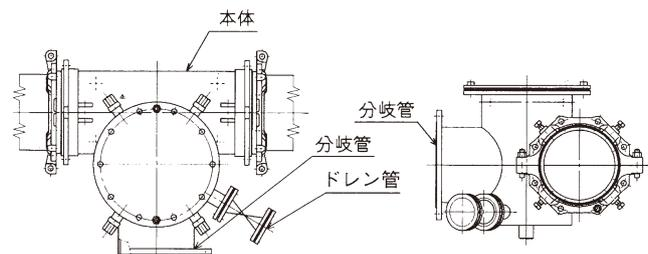
既設管を上部から穿孔し、既設管外径の約半分をC形にカットして、所要の分岐呼び径を管側方向に確保することを目的とした不断水分岐工法です。
