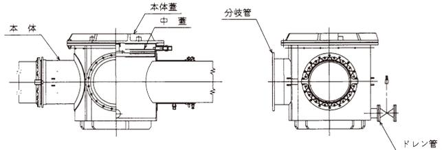
既設の障害物等が隣接し、横からの穿孔が不可能な場合、割T字管上部より穿孔し、既設管より任意の横方向に同時通水を行うことができます。
