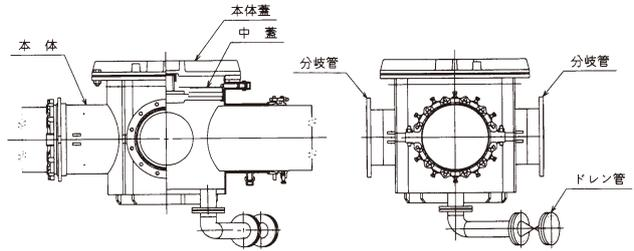
既設管の上部1ヶ所の穿孔により十字管設置と同様とすることを目的とした工法です。
