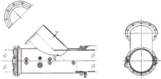
既設管からY字形に分岐管を不断水で取り出すことを目的とした工法です。
