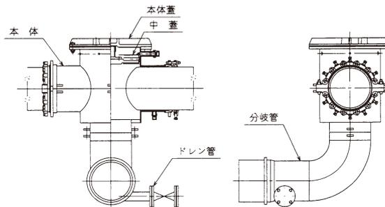
既設管を上部から穿孔し、管底部より分岐管を取り出すことを目的とした工法です。
