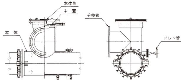
既設の障害物等が隣接し、横からの穿孔が不可能な場合、上部より穿孔し、割T字管上部より任意の方向に分岐します。
