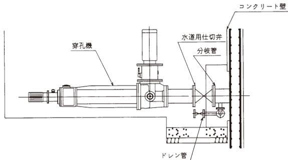
不断水工法を応用し、コンクリート構造物や壁に穿孔可能な工法です。
