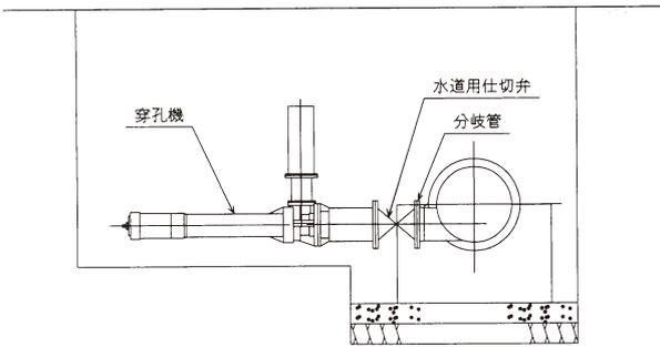
既設管の底部に、泥吐可能な分岐管を不断水で設置します。
