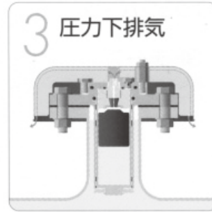
空気弁体に空気が溜まると、フロート弁体が作動(降下)し、小空気孔より排気。
