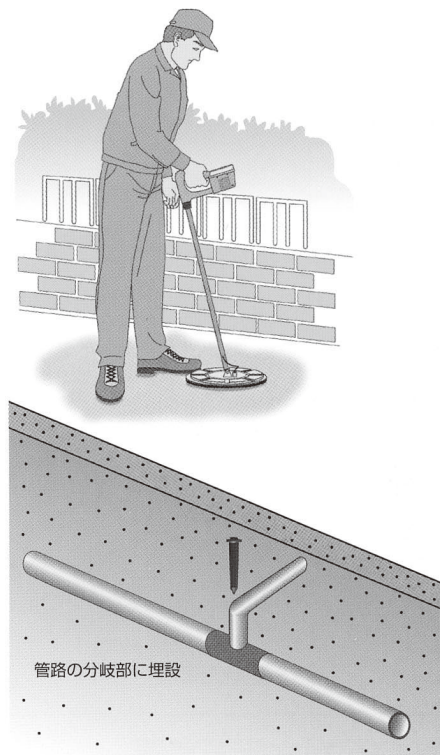
管路の探査例
