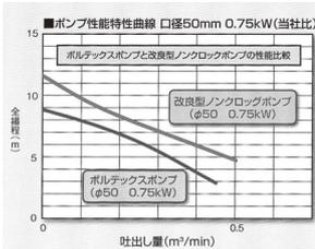
従来型だと1.5kWのモータ出力がKS-Nだと0.75kWに!!
