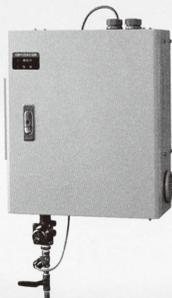
自動水質測定装置 TW-100は、上水施設や上水管・給水管末箇所に設置し、水質をモニタリングするシステムです。水道法で定められている毎日検査項目 濁度・色度・残留塩素及び水圧を標準測定。さらに pH・導電率・水温を加えた最大7項目の測定が可能です。本体はコンパクト設計で、無試薬・省令準拠した測定方式です。
