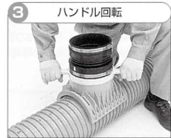
封印シールをはがし、ハンドルを時計回りに回転(約3回半)させます。
