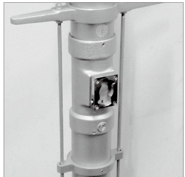
流量計表示部の取外しが可能
