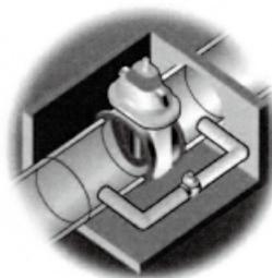
バイパス弁設置型は弁室が大きくなり、設置場所にさまざまな制約があります。埋設で充水弁体にするだけで、設置場所の制約が軽減できます。加えて、弁室及びバイパス管が不要となるので、トータルのコストダウンが期待できます。
