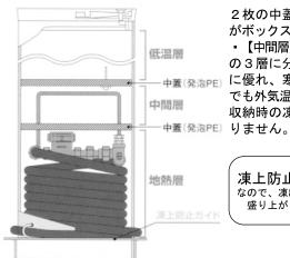
2枚の中蓋(発泡PE) がボックス内を【低温層】 - 【中間層】 - 【地熱層】 の3層に分割。断熱効果 中蓋(発泡PE) に優れ、寒冷地の厳寒期 でも外気温に左右されず、 収納時の凍結の心配があ
