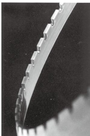
本製品には、高強度グリップリングが装着されています。2本のボルトを締め付けることによって、グリップリングの歯が管に食い込み、優れた脱管防止性能を発揮します。
