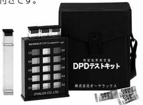
●製品構成 測定器本体(DPDコンパレーターセット済み)、テストチューブ(角形試験管:キャップ付) 4本、DPDプラス 50包、ハンディケース 1個。
